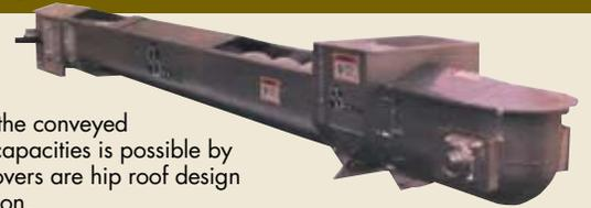
Полностью оцинкованный конвейер Flight-Veyor® модели «RB» оснащен желобом «U» - образной формы с округлым дном. Применяется там, где необходима тщательная очистка конвейера от перемещаемого продукта. Благодаря выбору размера желоба и скорости цепи, существует целый ряд конвейеров различной мощности. Кожух имеет форму четырехскатной крыши, что помогает избежать накопления воды или конденсата.
